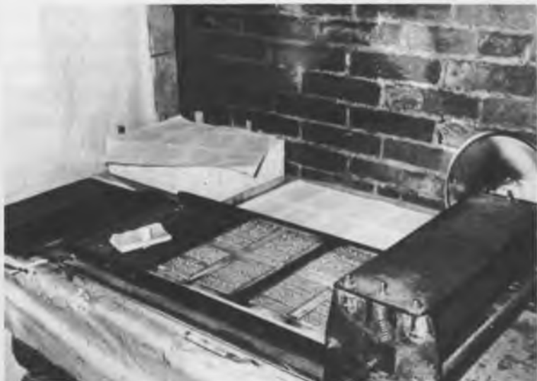
J. Stašaičio pagamintos ir J. Špoko name (Kaunas, Baršausko g. 5) įrengtos linotipinės spausdinimo staklės. (Iš buv. KGB archyvo)
